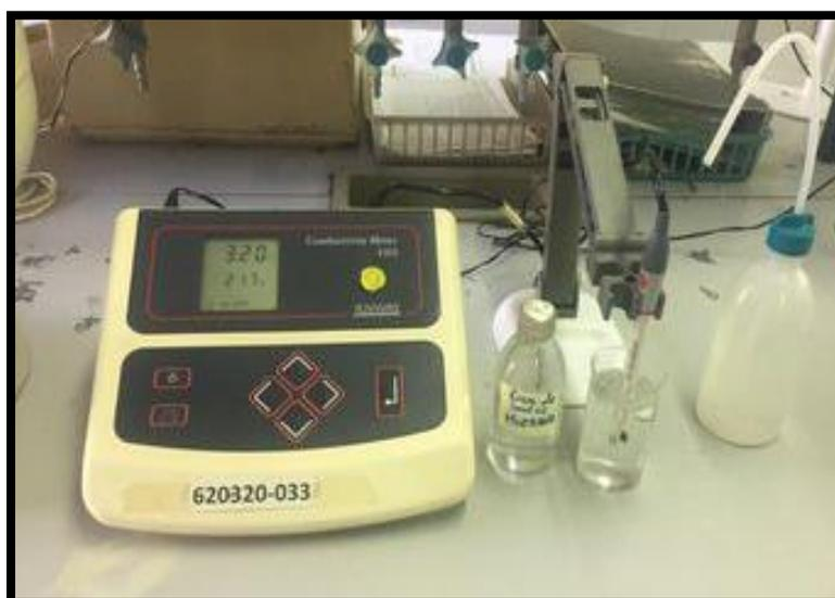
Figure 8 : Conductimètre (photographie originale, 2020).
