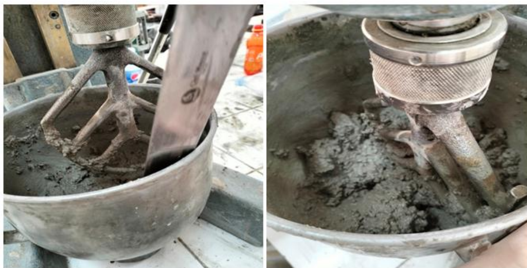
Figure II.17 : Préparation du mortier témoin.
