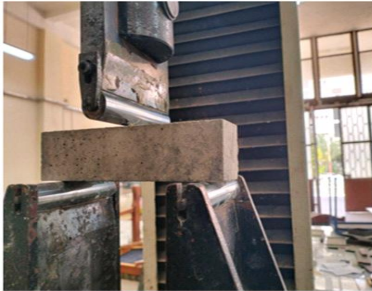
Figure III.1 : Éprouvette soumise à la traction par flexion trois points.
