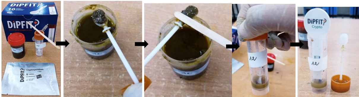
Figure 41 : Étapes de réalisation de l'analyse de BIO K 387 - DipFit Cryptosporidium parvum (Originale, 2023).
