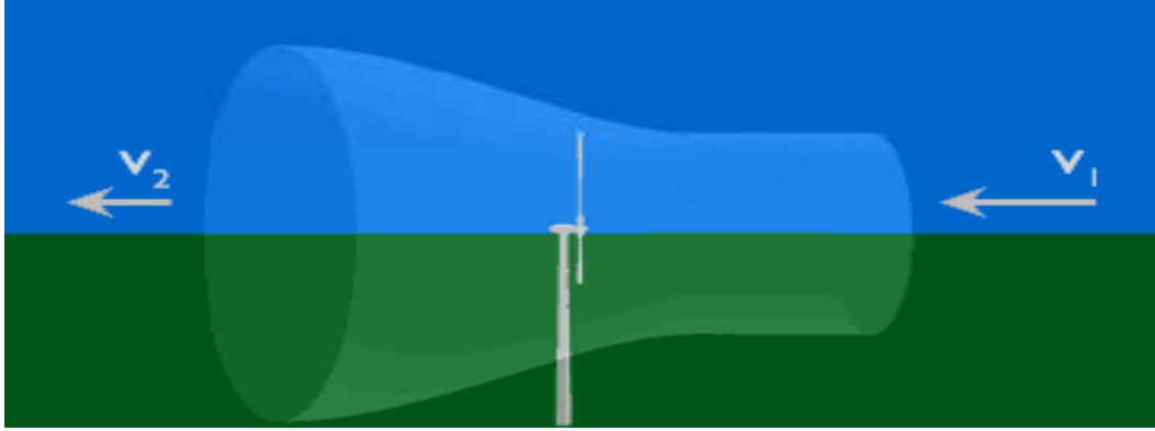
Figure II-1 : Tube de courant d'air autour d'une éolienne.
