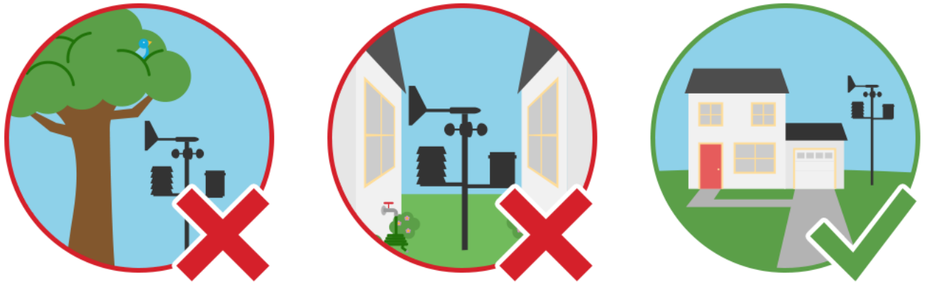
Figure 1 .schéma de positionnement d'une station météorologique
