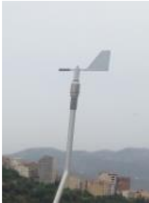
Figure 9. La girouette a codage optique
