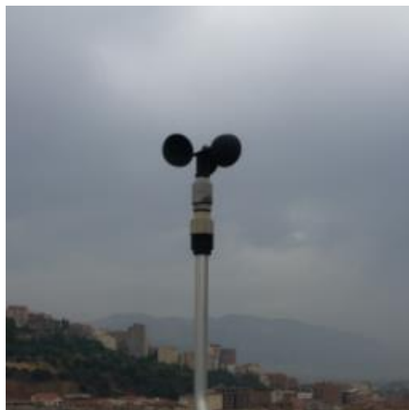
Figure 7. L'anémomètre à codage optique
