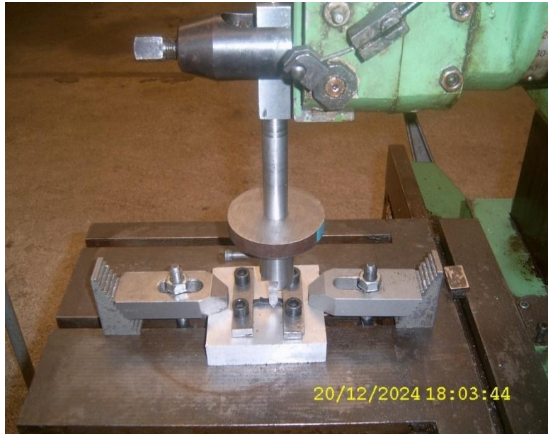
Figure III.23 : Montage d'étude de mécanisme d'usure abrasive
