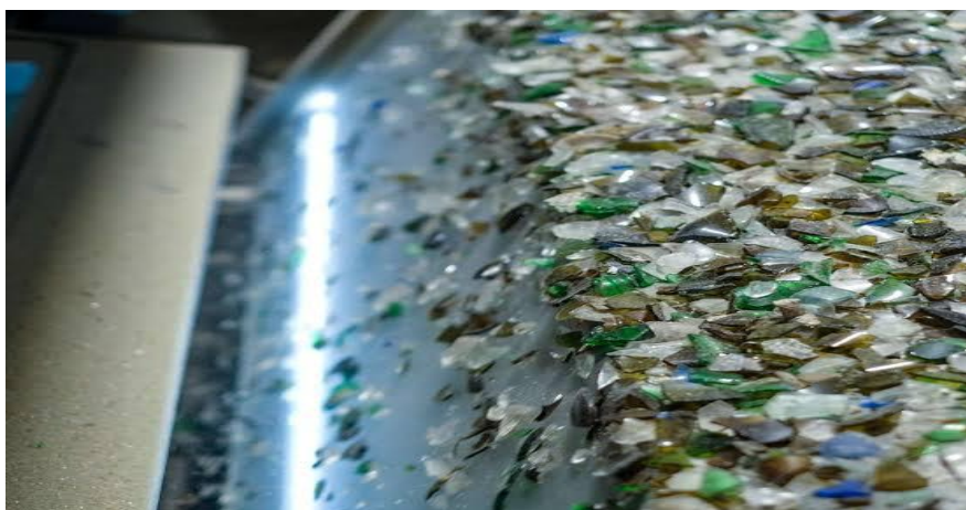
Figure V. 1 : calcin de verre trié destiné à la fabrication de laine de ver
