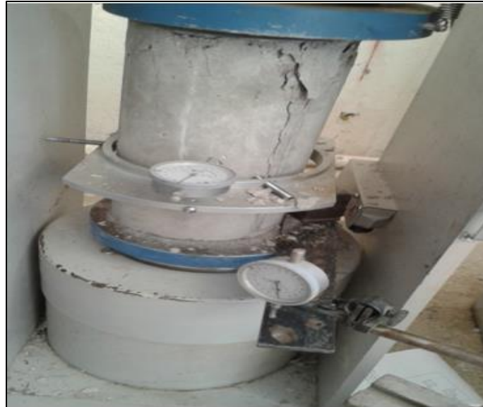
Figure III.14 : Rupture d'une éprouvette par essai de compression.
