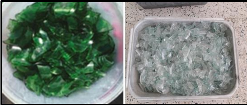
Figure III.6 : Broyage des bouteilles (verre coloré et verre non coloré).
