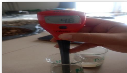
Figure 20 : mesure du pH avec un pH mètre
