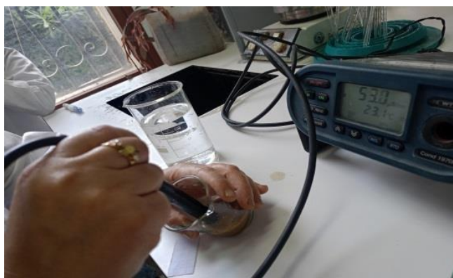
Figure 22 : mesure de la conductivité avec un conductimètre
