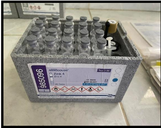
Figure II.7: Réactifs du dosage de zinc.
