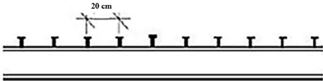
Figure VI.8. Espacement entre les connecteurs.
