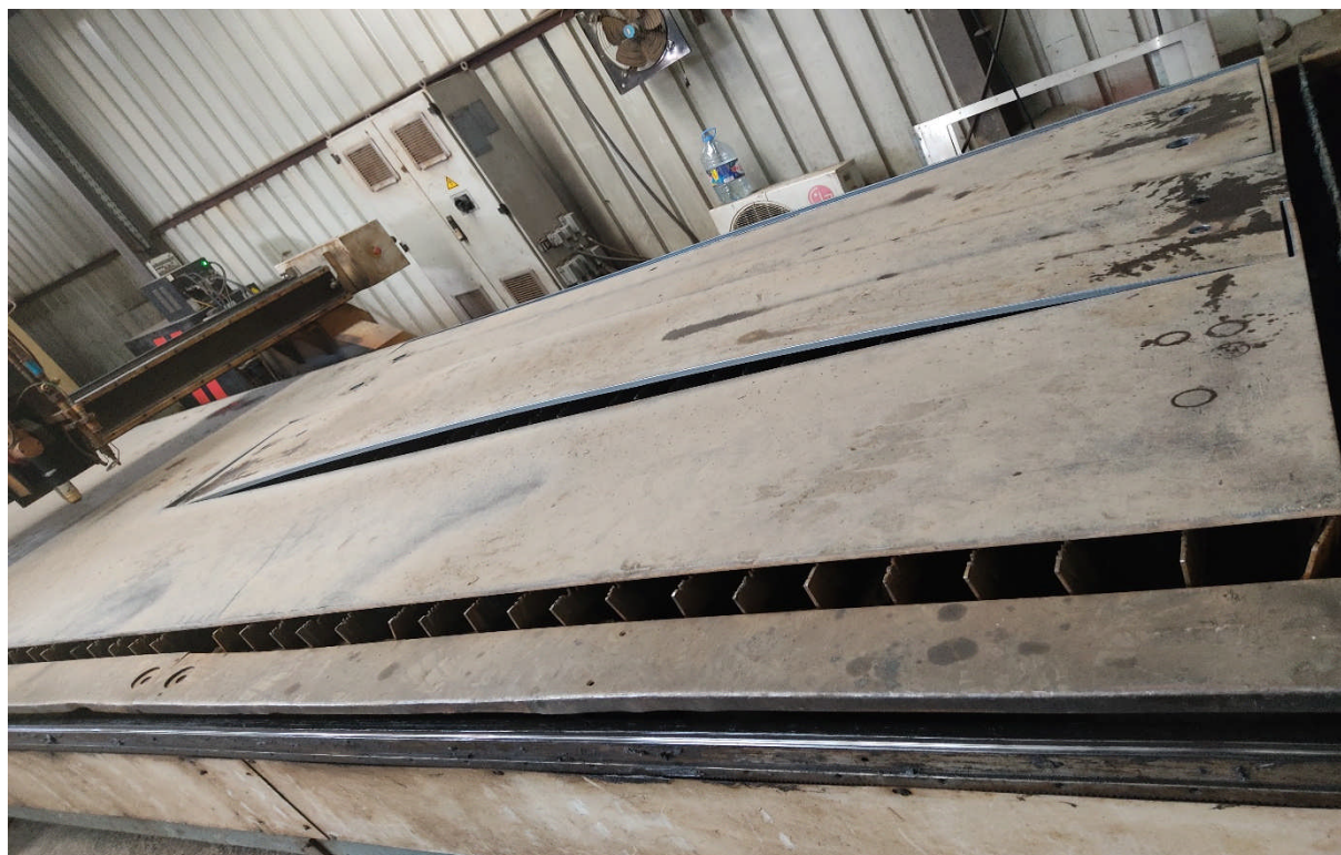
Figure □- 1: Déformation de la tôle causée par une basse pression
