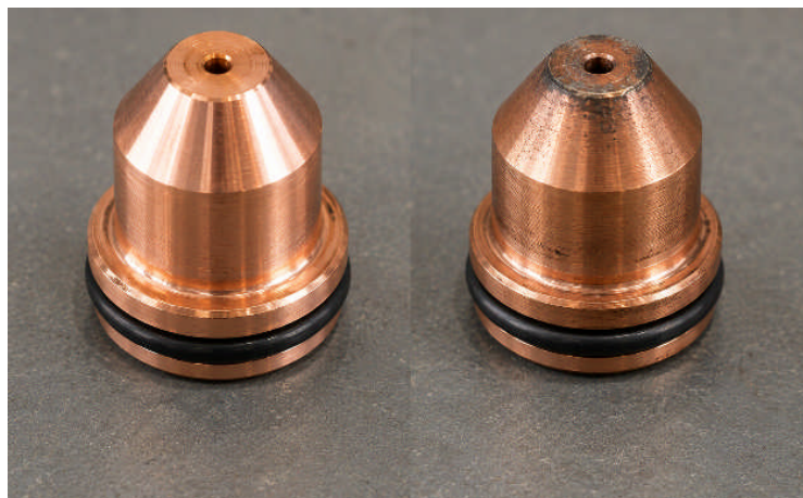
Figure □- 28: la dégradation d'une buse en fonction d'usage
