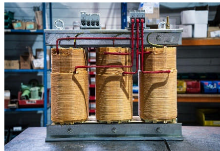
Figure □- 9: transformateur de puissance
