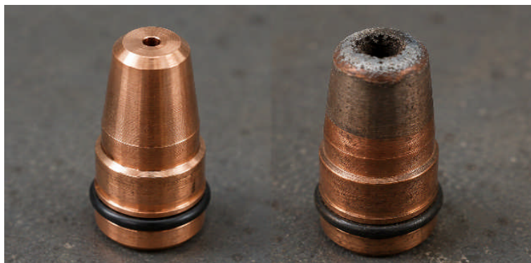
Figure □- 26: la dégradation d'une électrode en fonction d'usage
