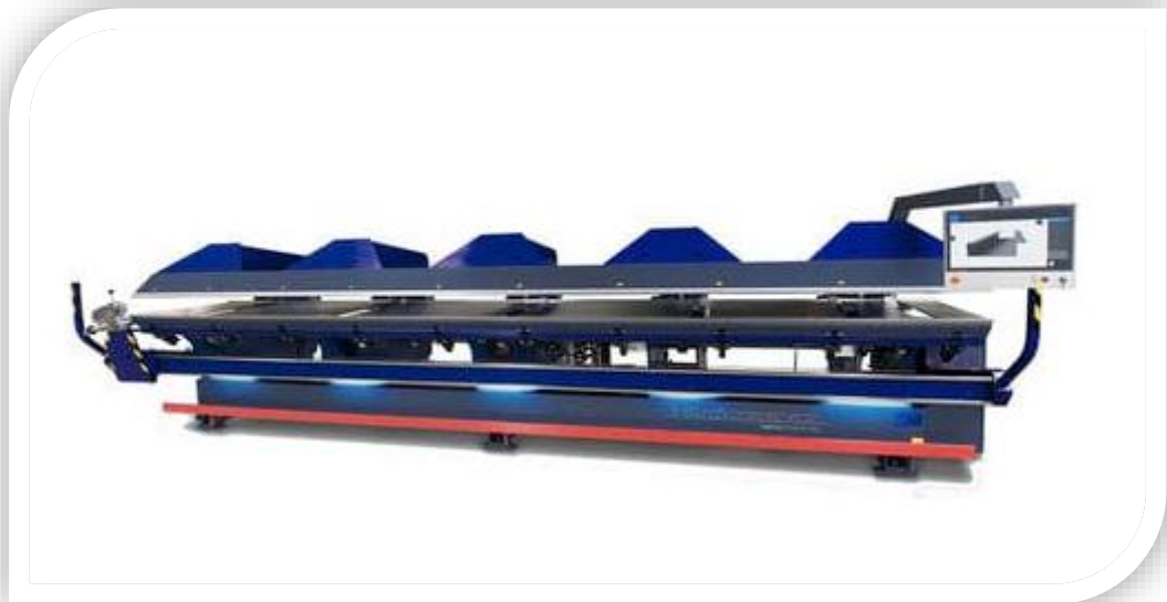
Figure N° 17 : ligne de pliage
