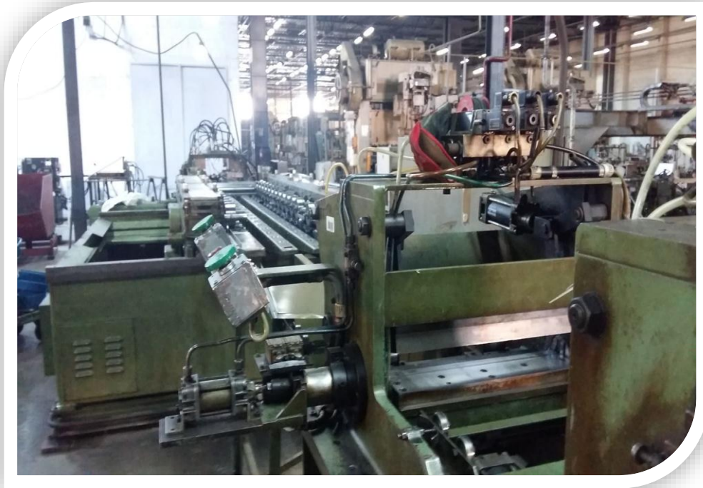
Figure N° 11: ligne de refondage (ENIEM)
