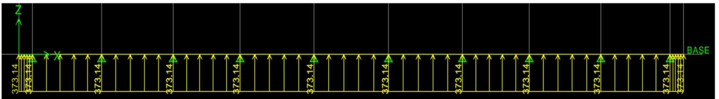
Figure VII.7 : Diagramme des efforts tranchants à l'ELU (Sens longitudinal).
