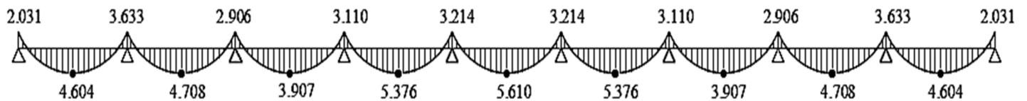
Figure III.2.8: Diagramme des moments fléchissant à l'ELU
