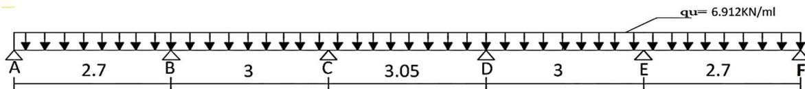
Figure III.2.10: Schéma statique de la poutrelle
