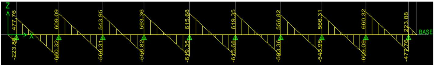
**Figure VII.13 : Diagramme des efforts tranchant à l'ELU (Sens longitudinal )**
