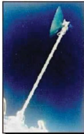
**Figure II.2 Mât d'antenne du satellite Hubble 6061 / 40% fibres de carbone.**
