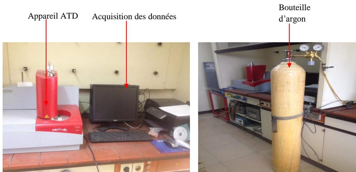
**Figure III.17. Appareillage d'analyse thermique différentielle.**
