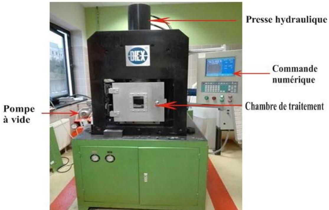
Figure III.10. Le four de pressage à chaud utilisé.
