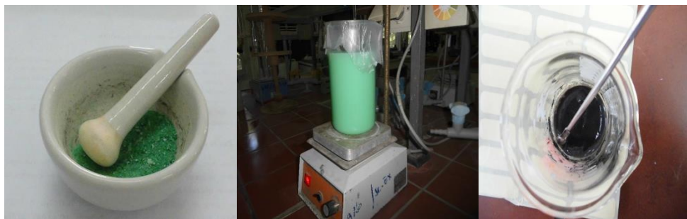
Figure II.1 : Etapes de synthèse de BaNiO 3 par co-précipitation.
