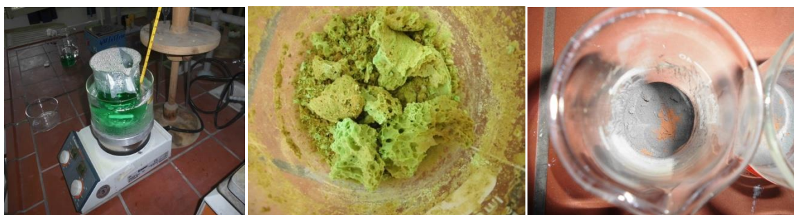
Figure II.2 : Etapes de synthèse de \text{BaNiO}_3 par sol-gel
