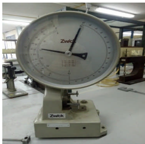
Figure IV.19 : Mouton pendule (machine d'essai de résilience)
