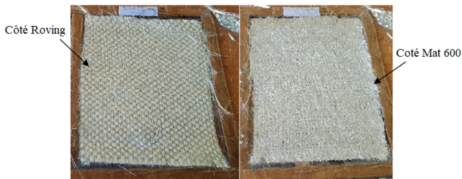
Figure IV.3 le renfort utilisé et ses deux faces (roving et mat de 600)
