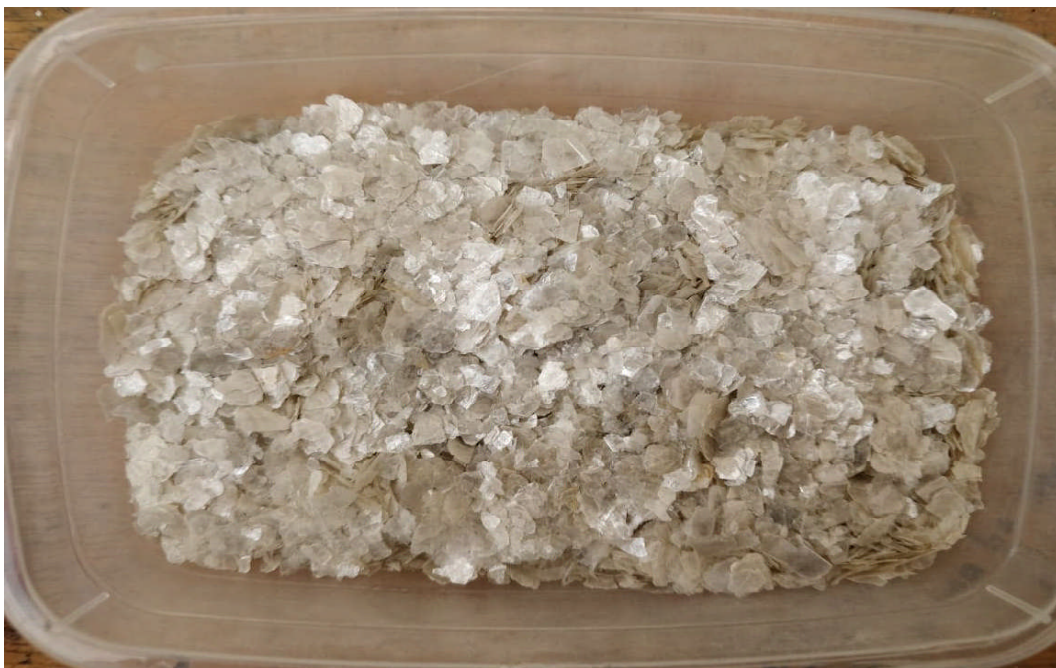
Figure IV .9 photo de Granulométrie de mica comprise entre 1mm et 5mm
