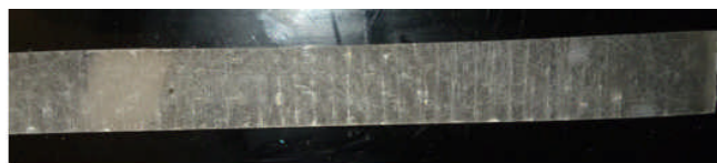
Figure IV.15 éprouvette de traction du matériau composite
