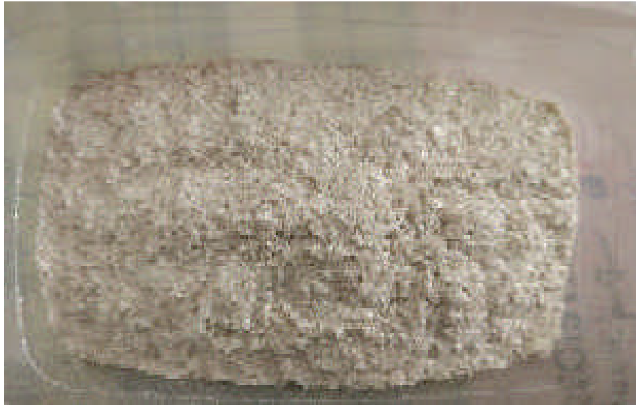
Figure IV .8 photo de Granulométrie de mica inférieure à 1mm 2 ème particules de granulométrie entre 1mm et 5mm ( 1\text{mm} < G_2 < 5\text{mm} ) ;
