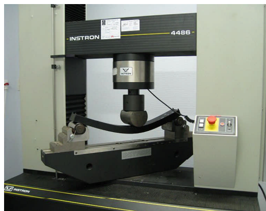
Figure III-7: Dispositif de flexion trois points
