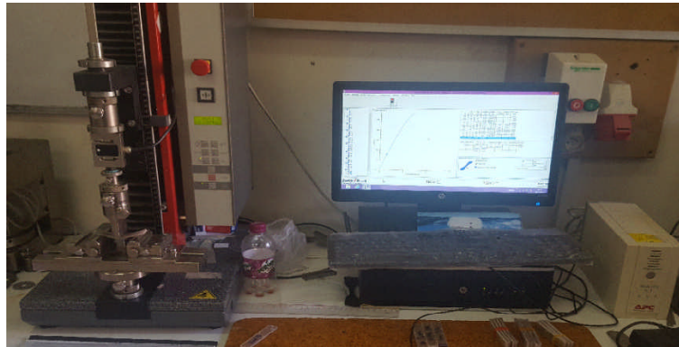
Figure IV.16 machine de traction utilisée pour les essais de flexion zwick/Roell
