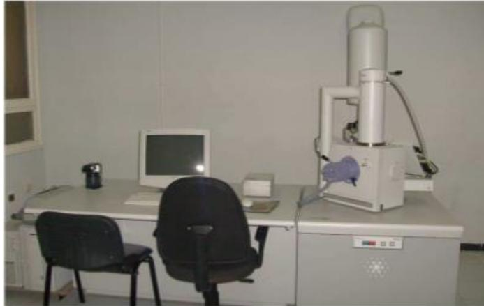
**Figure IV.38** : Microscope électronique à balayage
