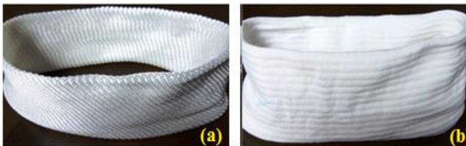
**Figure IV.1** : Renforts utilisés : a) fibres de verre, b) Perlon (PA66).
