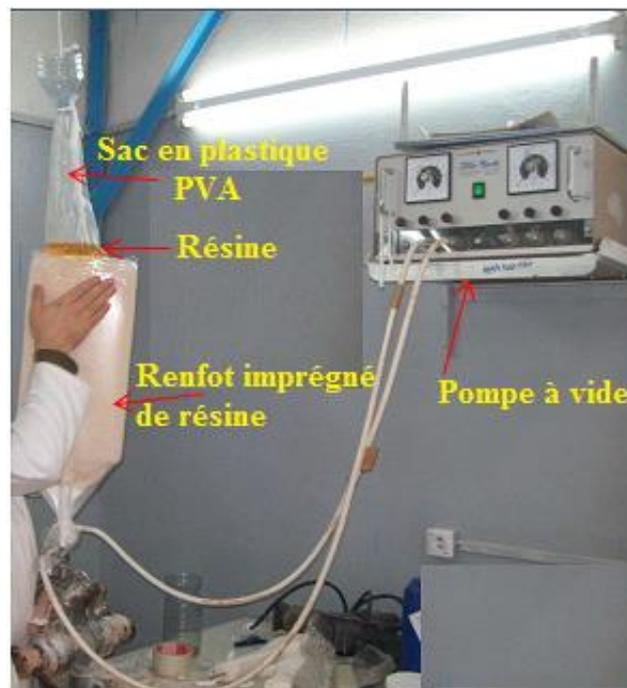
**Figure IV.2** : Procédé d'injection au sac sous vide.
