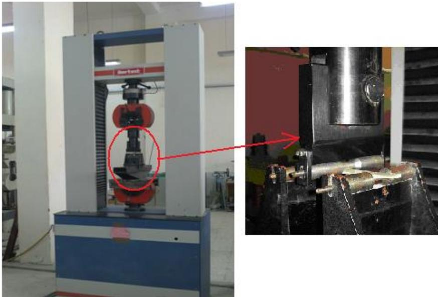
Figure IV.6 : Machine et dispositif de flexion trois points
