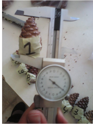
Figure11 :mesure des cones a l'aide d'un pied à coulisse.
