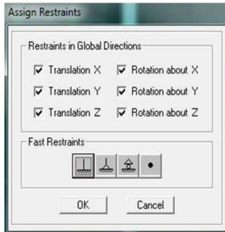
Fig.IV.15: Encastrement des appuis
