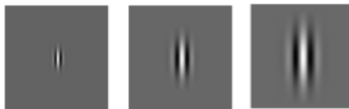
Figure .1 : la taille de filtre pour différentes longueurs d'ondes
