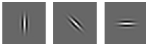
Figure .2 : changement de la direction du filtre en modifiant \theta .
