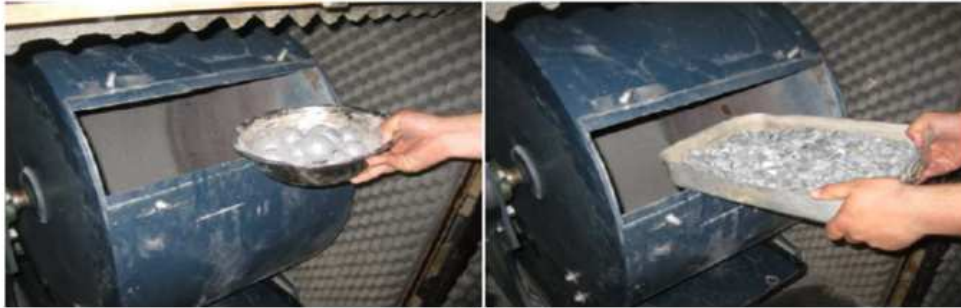
Figure V.5 : Mise en place des granulats pour l'essai Los Angeles.
