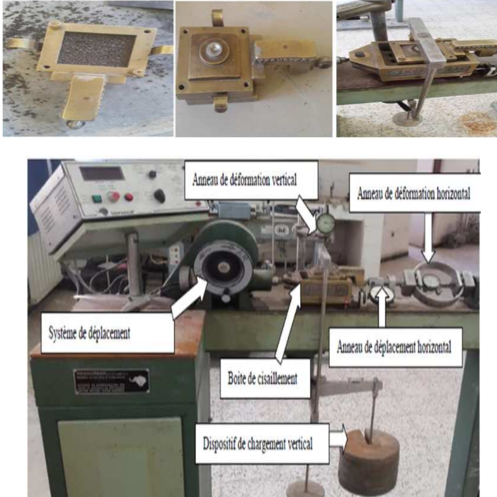
Figure VI.8 : Appareillage de l'essai de cisaillement à la boîte.
