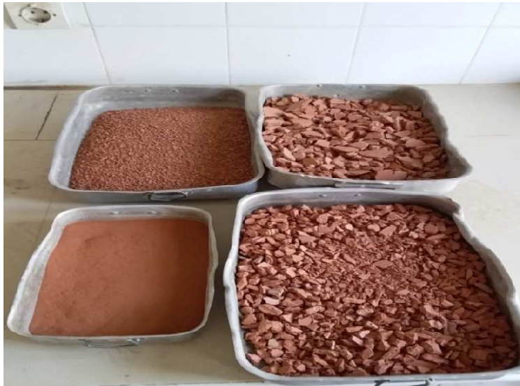
Figure III.19 :Débris de brique après concassage et tamisage.
