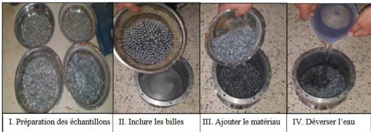
Figure V.2 : Mode opératoire de l'essai micro Deval.
