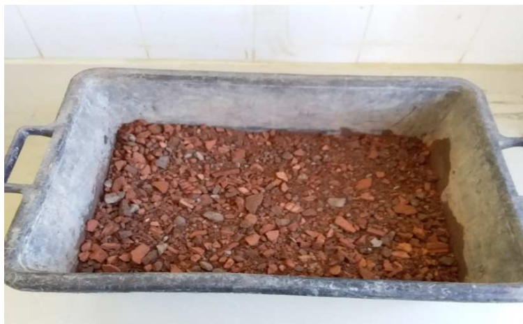
Figure IV.7 : Mélange de marne+ Débris de brique préparé pour essai Proctor.
