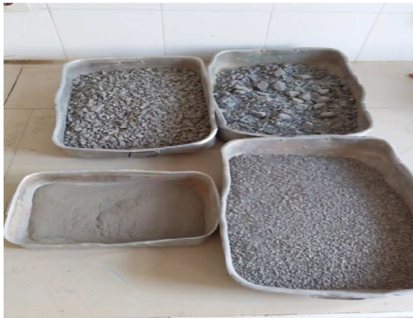
Figure III.10 : Granulats de marne après concassage et tamisage.
