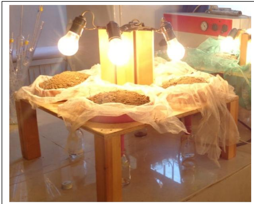
Figure 3. Dispositif de récolte des invertébrés (Appareil de Berlèse)
