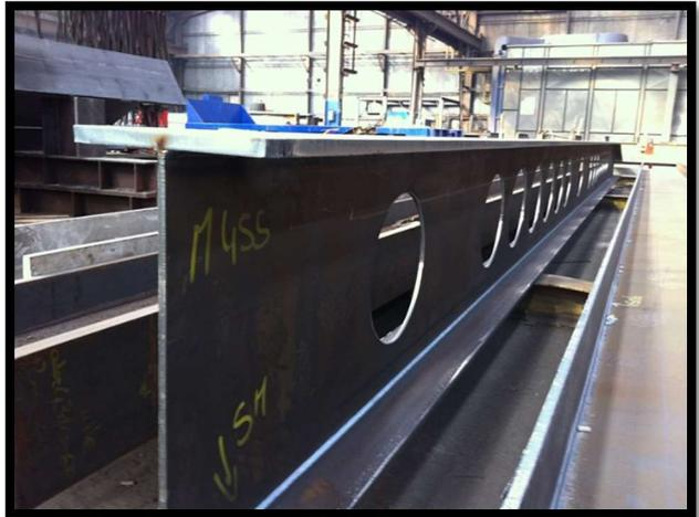
Figure III.42 : image d'une poutre alvéolaire.
