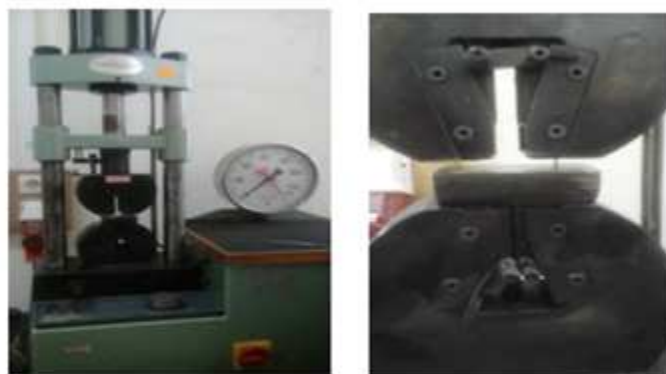
Figure III.3 : Machine utilisée pour la compression des échantillons
