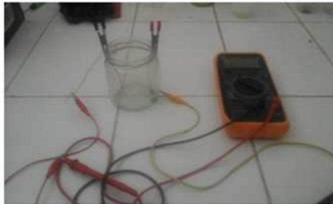
Figure III.12 : montage essai de corrosion libre de l'aluminium 1370.
