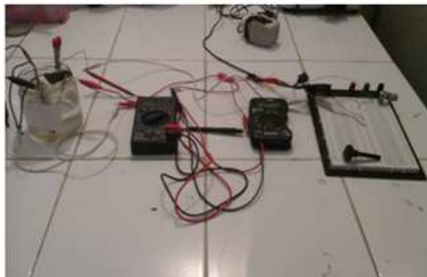
Figure III.13 : montage essai de corrosion sous une tension imposée de l'aluminium 1370.
