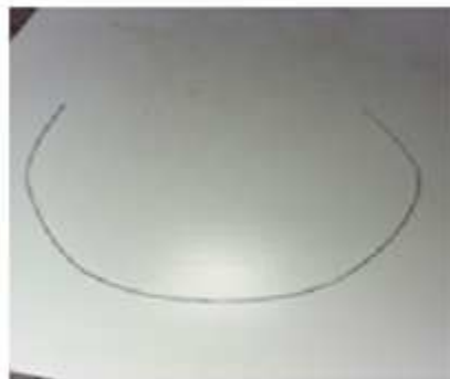
Figure III.1 : fil d'aluminium 1370 utilisé avant de la couper
