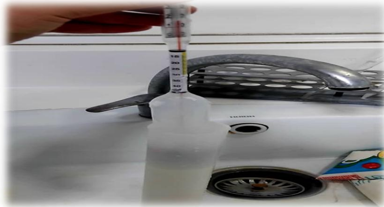
Figure 6. Mesure de la densité du lait cru à l'aide d'un thermo-lactodensimètre.
