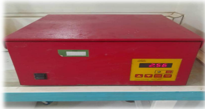
Figure 9. Centrifugeuse utilisée pour la détermination de la teneur en matière grasse du lait.
