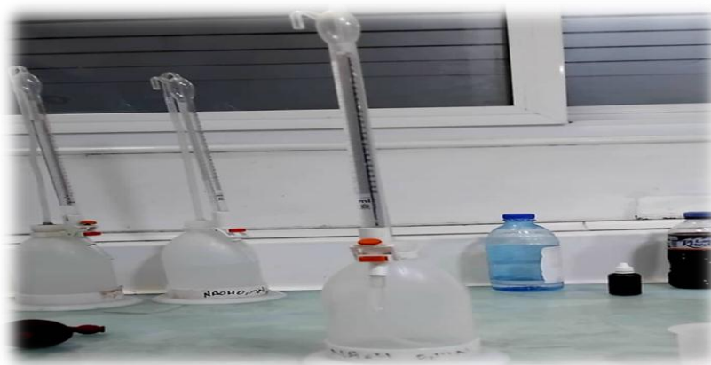
Figure 7. Burette automatique utilisée pour le titrage de l'acidité du lait cru avec une solution de soude NaOH.
