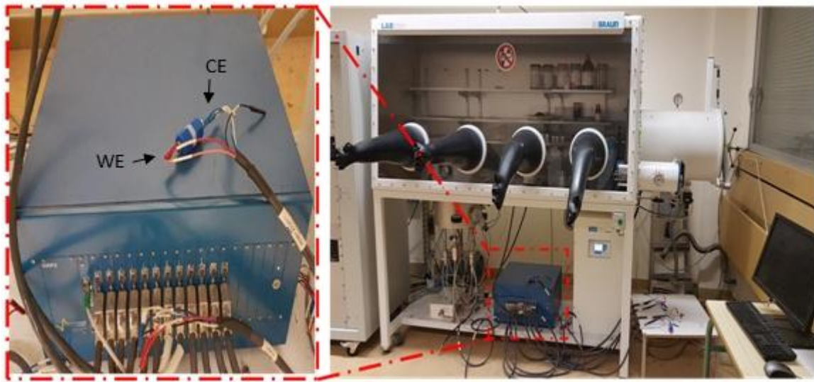
Figure II.8. Boîte à gants utilisée pour l'assemblage des cellules à deux électrodes.
