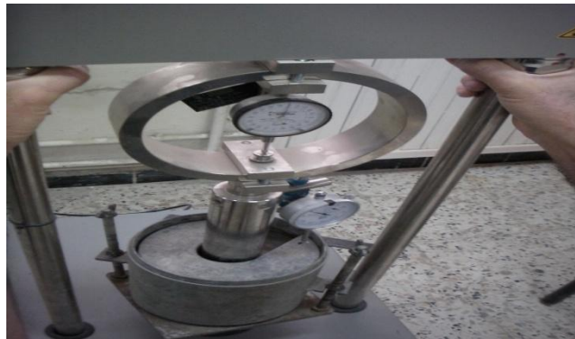
Figure V.9 : Placer l'appareillage pour poinçonnement
