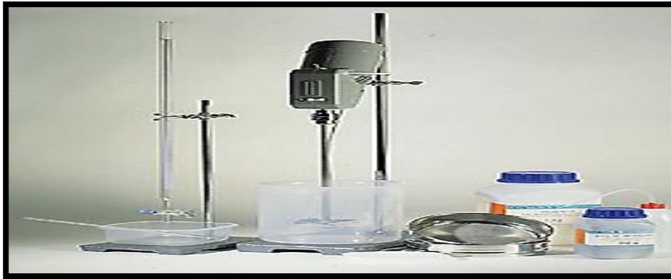
Figure 38.I : Mesure de la quantité et de l'activité de la fraction argileuse (Valeur de bleu de méthylène) - NF P 94-068
