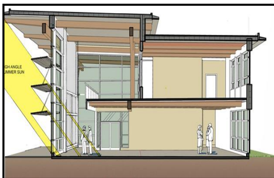
Figure 95 : coupe schématisée représente la pénétration de l'éclairage naturelle. Source : http://www.inlandtechnical.ca/
