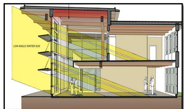
Figure 95 : coupe schématisée représente la pénétration de l'éclairage naturelle. Source : http://www.inlandtechnical.ca/
