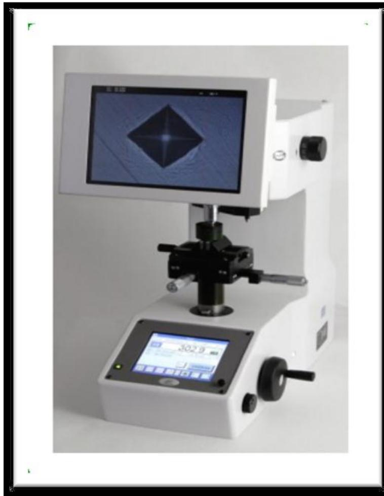
**Figure III.7.** Machine de mesure de la microdureté
