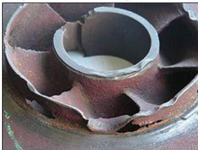
**Figure II.9.** Pièces usées par cavitation.
