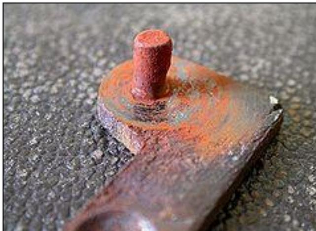
**Figure II.8.** Aspect des dégâts des pièces endommagées par corrosion de contact.
