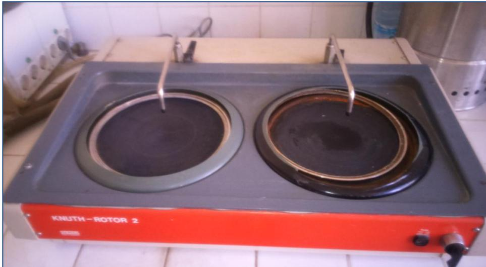
**Figure III.4.** Polisseuse à deux disques.
