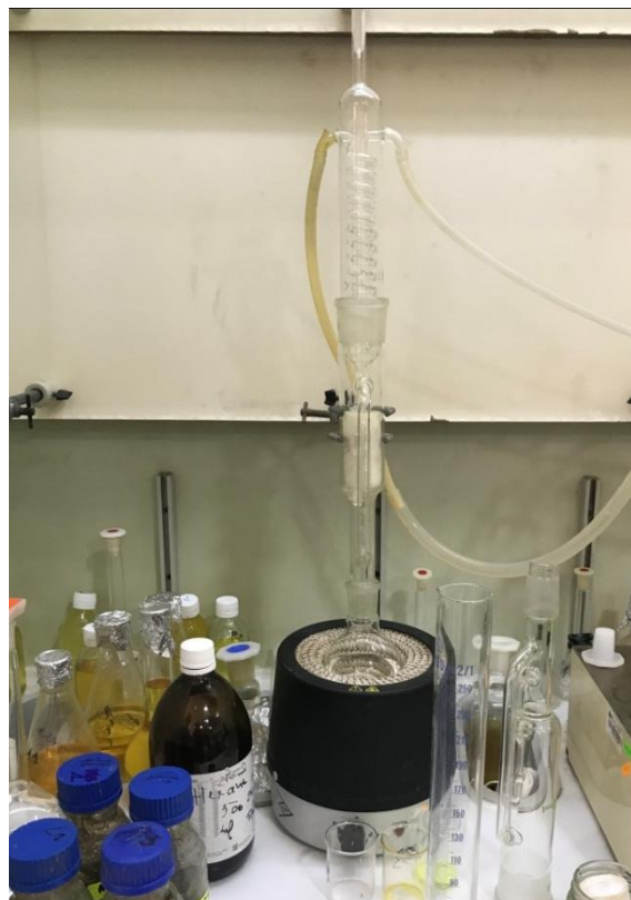
Figure 9 : Montage expérimental de l'extraction par Soxhlet
