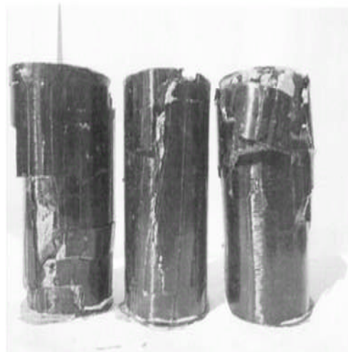
Figure II-16: Mode de rupture des cylindres enveloppés avec fibres de carbone [43]
