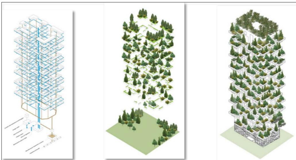
Figure 76 : le système d'irrigation de Bosco verticale
