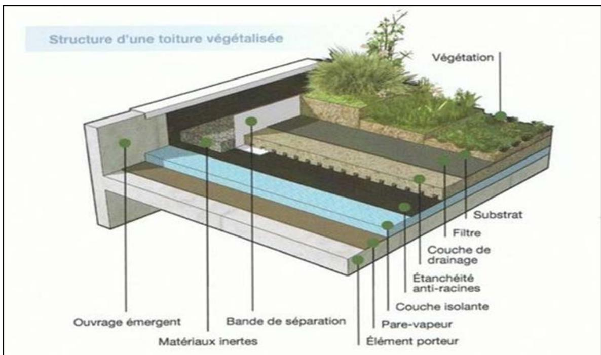
Figure 187 : Détails de toiture végétalisée.
