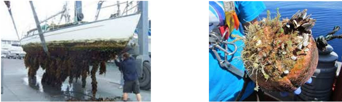
Fig III.12: les biofilms sur des coques de navire [11]
