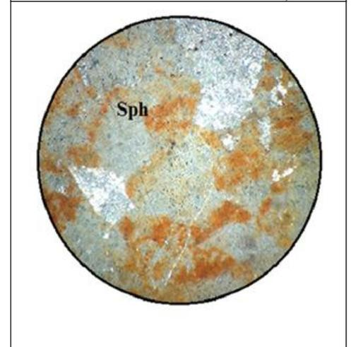
**Figure 58 :** Microphotographie de la Sphalérite avec une teinte brunâtre (L.M G X 10)
