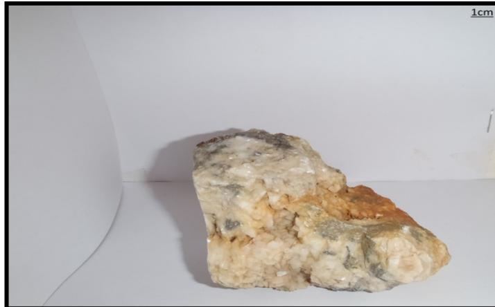
**Figure 49** : Photo montrant une texture de crustification de dolomite rose sertie de moucheture de pyrite cuivreuse et Barytine.
