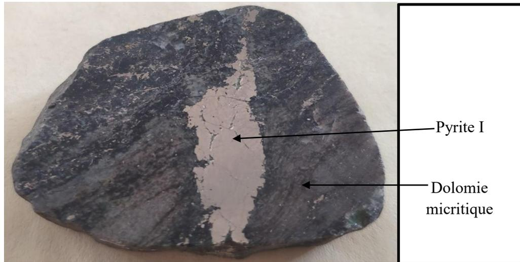
**Figure 63 :** Photographie d'un échantillon de Dolomie micritique associée avec la Pyrite
