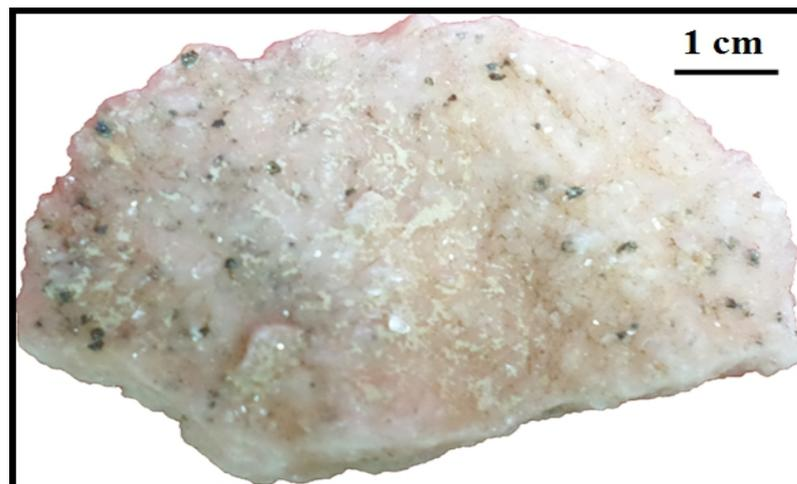
**Figure 52 :** Photo montrant une texture de crustification de dolomite rose sertie de moucheture de pyrite cuivreuse.
