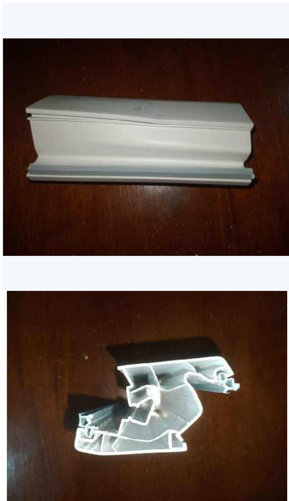
Figure 62 photographie du profilé a 50% de charge et 195°C après essai de compression découpé au point d'application de la charge
