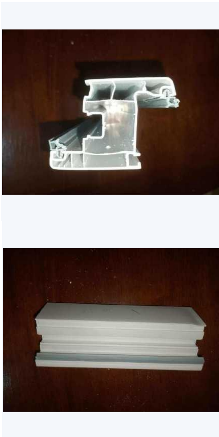
Figure 52. photographie du profilé à 50% de charge et 187°C après essai de flexion découpé au point d'application de la charge
