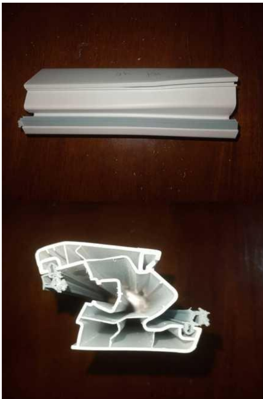
Figure 56 photographie du profilé à 40% de charge et 187°C après essai de compression Découpé au point d'application de la charge
