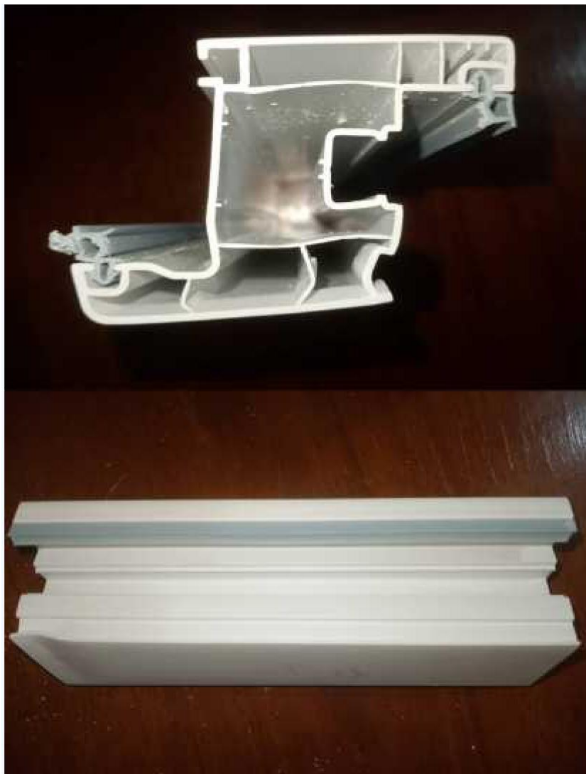
Figure 48 photographie du profilé à 40% de charge et 187°C après essai de flexion découpé au point d'application de la charge
