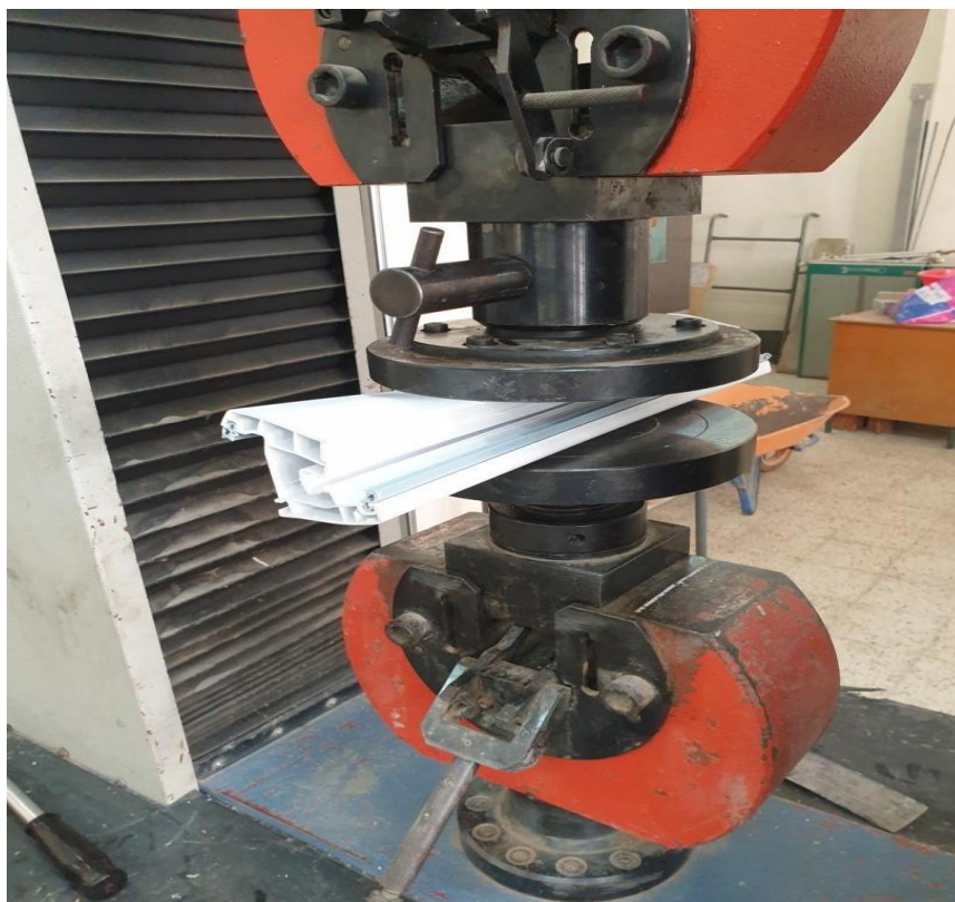
Figure 38. Essai de compression sur le profilé ouvrant fenêtre.
