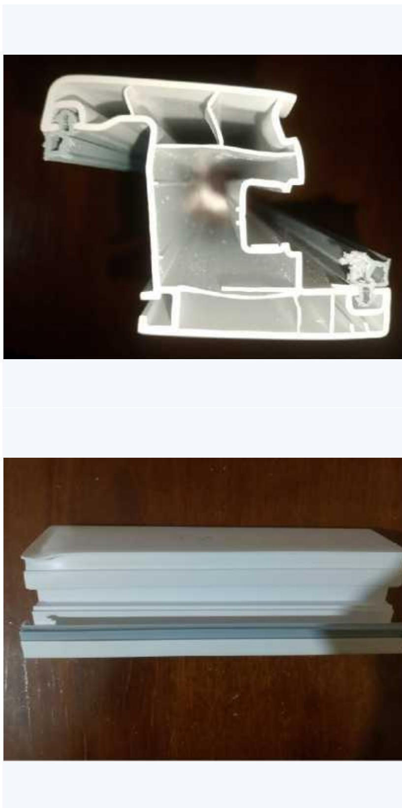
Figure 50 photographie du profilé à 40% de charge et 195°C après essai de flexion découpé au point d'application de la charge
