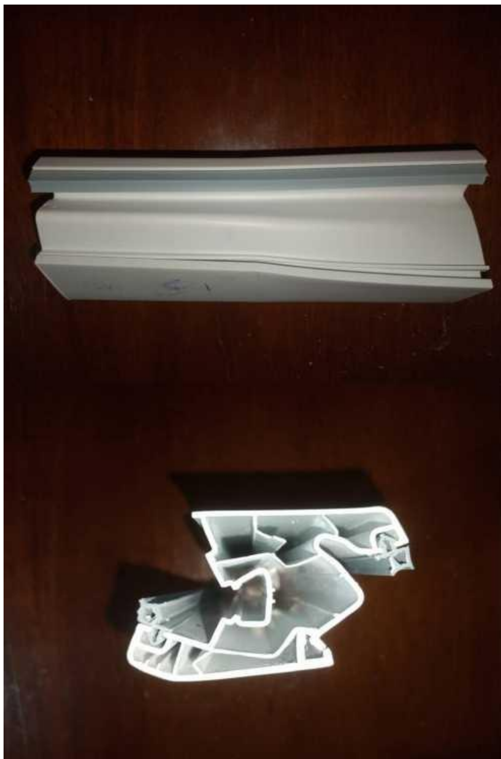
Figure 58 photographie du profilé a 40% de charge et 195°C après essai de compression découpé au point d'application de la charge
