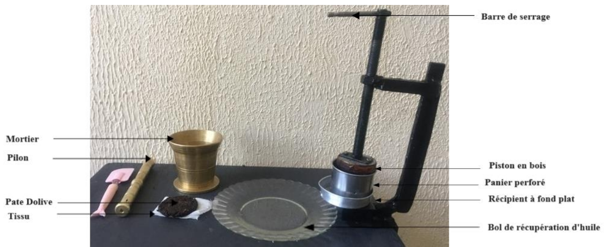
Figure 13 : Processus d'extraction d'huile d'olive appliqué au laboratoire.
