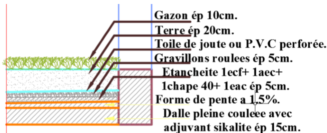
Figure 17 : Les composants de la toiture végétalisée
