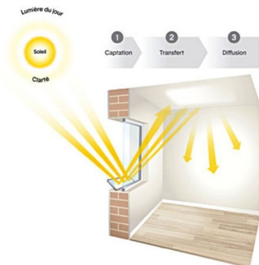
Figure09 : Le fonctionnement d'un panneau déflecteur/Source : https://www.batiproduits.com/fiche/produits/panneau-deflecteur-pour-optimisation-de-l-eclair-p69133003.html .
