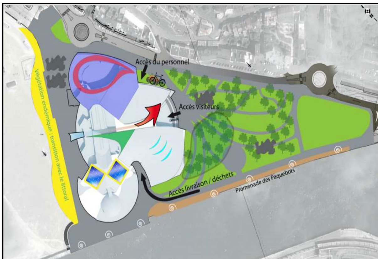
Figure 104 : les dispositifs bioclimatiques adoptés sur le musée de Nausicaa –Boulogne sur mer Source : Etude d'impact dans le cadre du permis de construire, Eric MARTIN, juin 2015.
