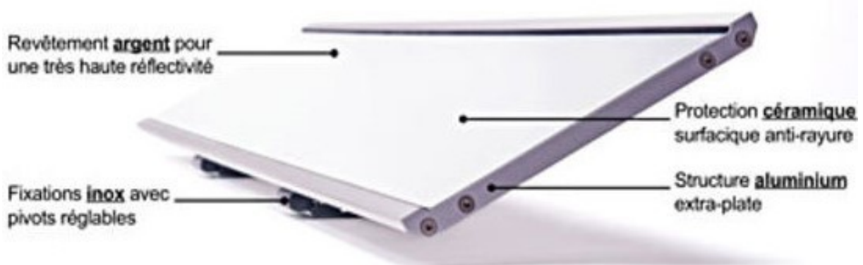
Figure11 : Les composants d'un panneau déflecteur
