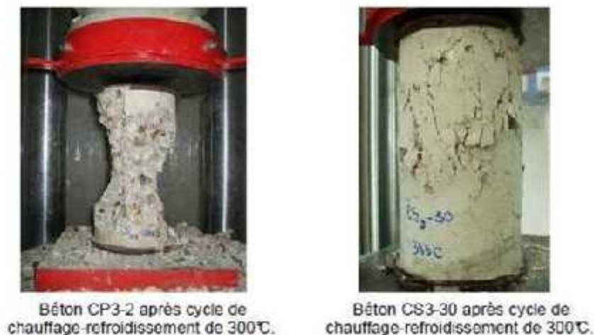
Figure III.11 : Test de compression de bétons de fibres de polypropylène et métalliques après traitement thermique à 300°C [52].
