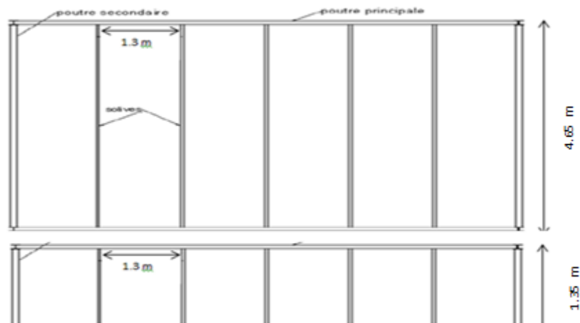
Figure V-2. Disposition des poutrelles
