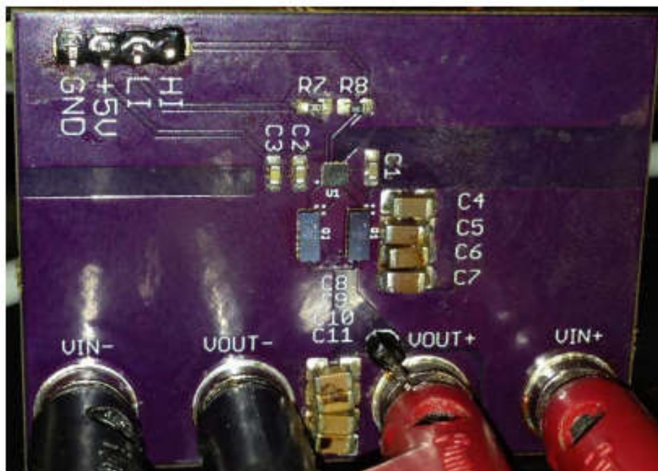
Figure ( I. 2 ) : émulateur de source PV [3]
