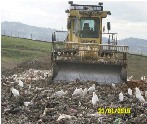
**Figure 11-a :** Epannage-Compactage des déchets (EPWG CET, 2015).
