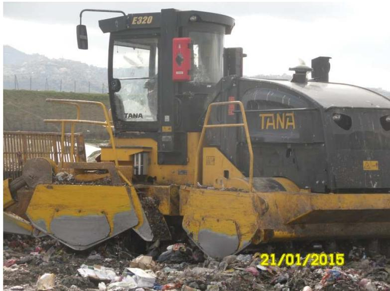
**Figure 13 :** Compacteur à pied de mouton type TANA E320 (Photo originelle 2015).
