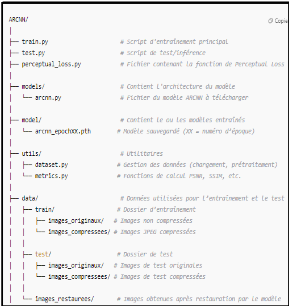
Figure 30: Structure finale du projet développée
