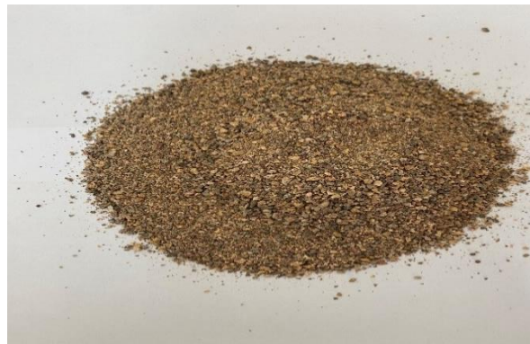
Figure II-6: Sable de carrière concassé
