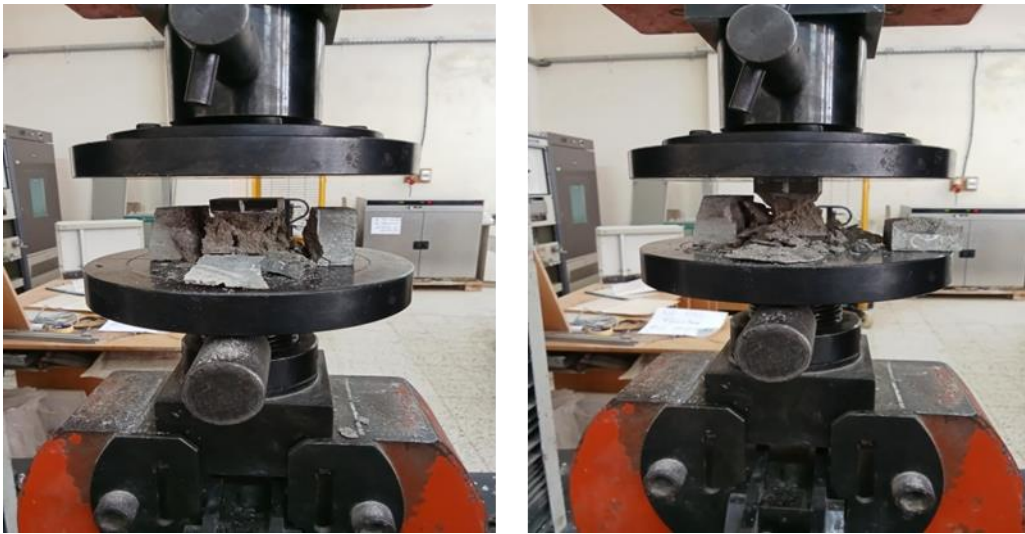
Figure II-18 : Test de résistance à la compression.
