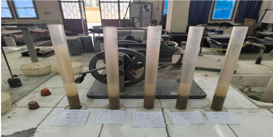
Figure II-12: Essai de l'Équivalent de Sable tel que mené au niveau du laboratoire béton-UMMTO.
