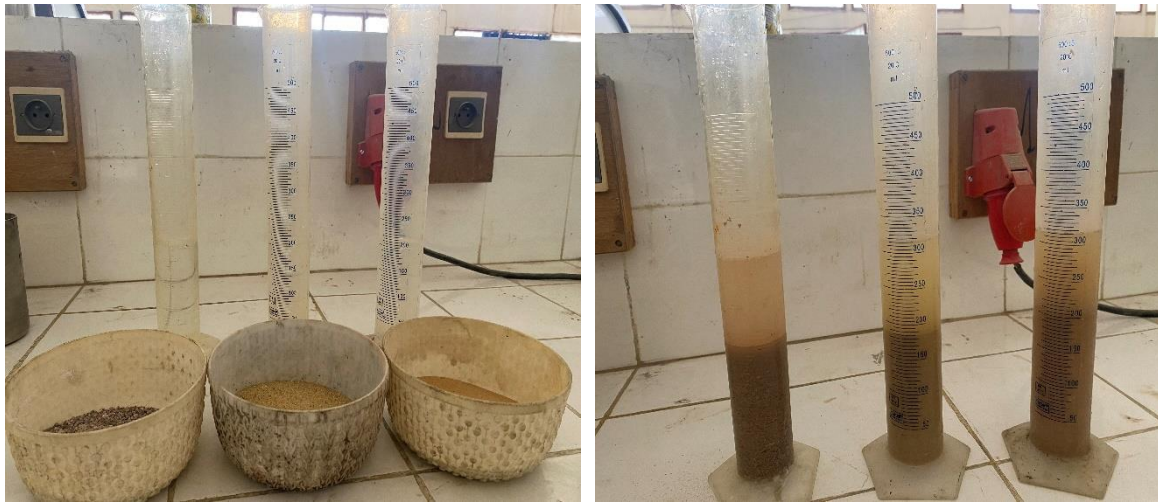
Figure II-10: Essai de détermination de la masse volumique absolue
