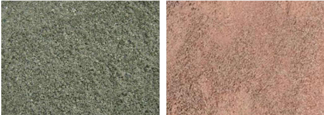
Figure I-4 : Les sables de concassages
