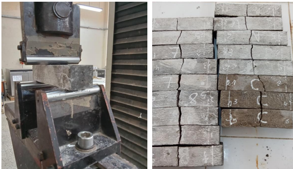
Figure II-16: Test de résistance à la flexion.
