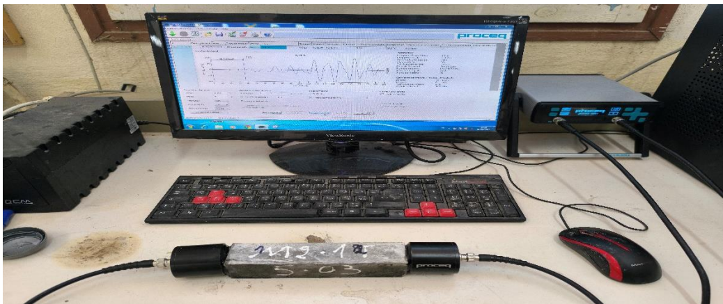
Figure II-14: Mesure de la vitesse ultrasonore.
