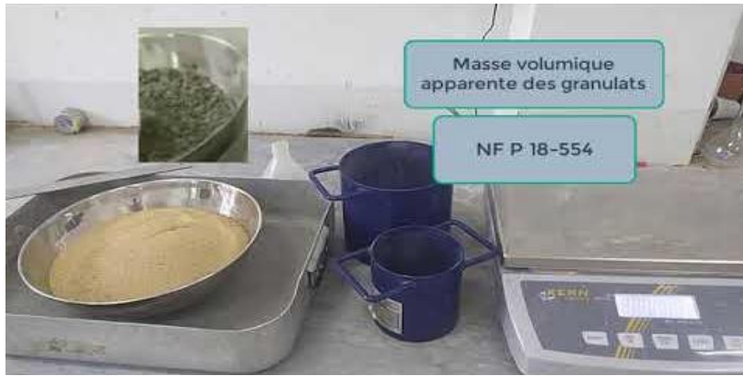
Figure II-9: Essai de la détermination de la masse volumique apparente
