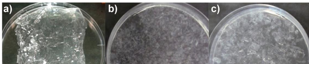
Figure 14 : Pellicules de PVC incubées en condition abiotique (a) et en présence de P. citronellolis (b) ou de B. flexus (c) pendant 70 jours (GIACOMUCCI et al. , 2019).
