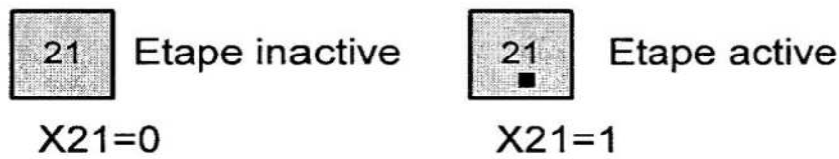
Figure 2.2 : Etape inactive et étape active
