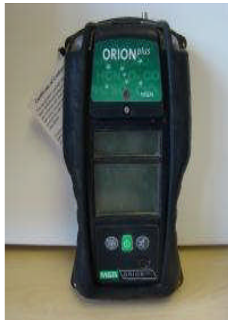
ORION+ (détection de CO 2 IR)
