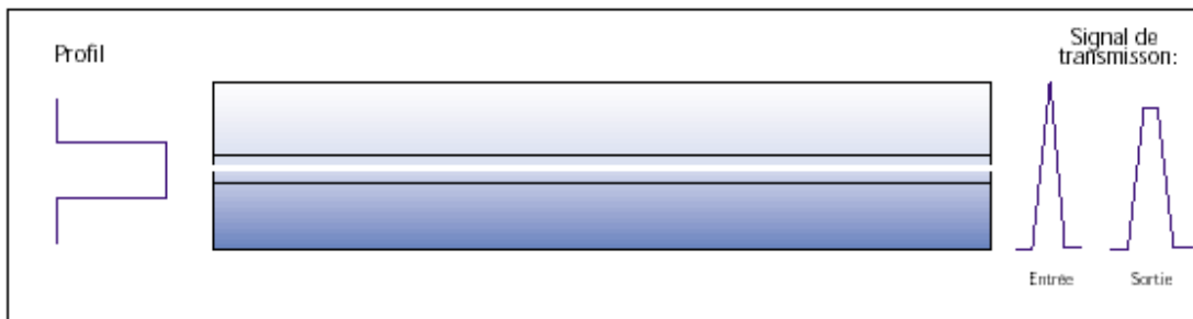
Figure II.10: Canal de transmission pour la fibre monomode.
