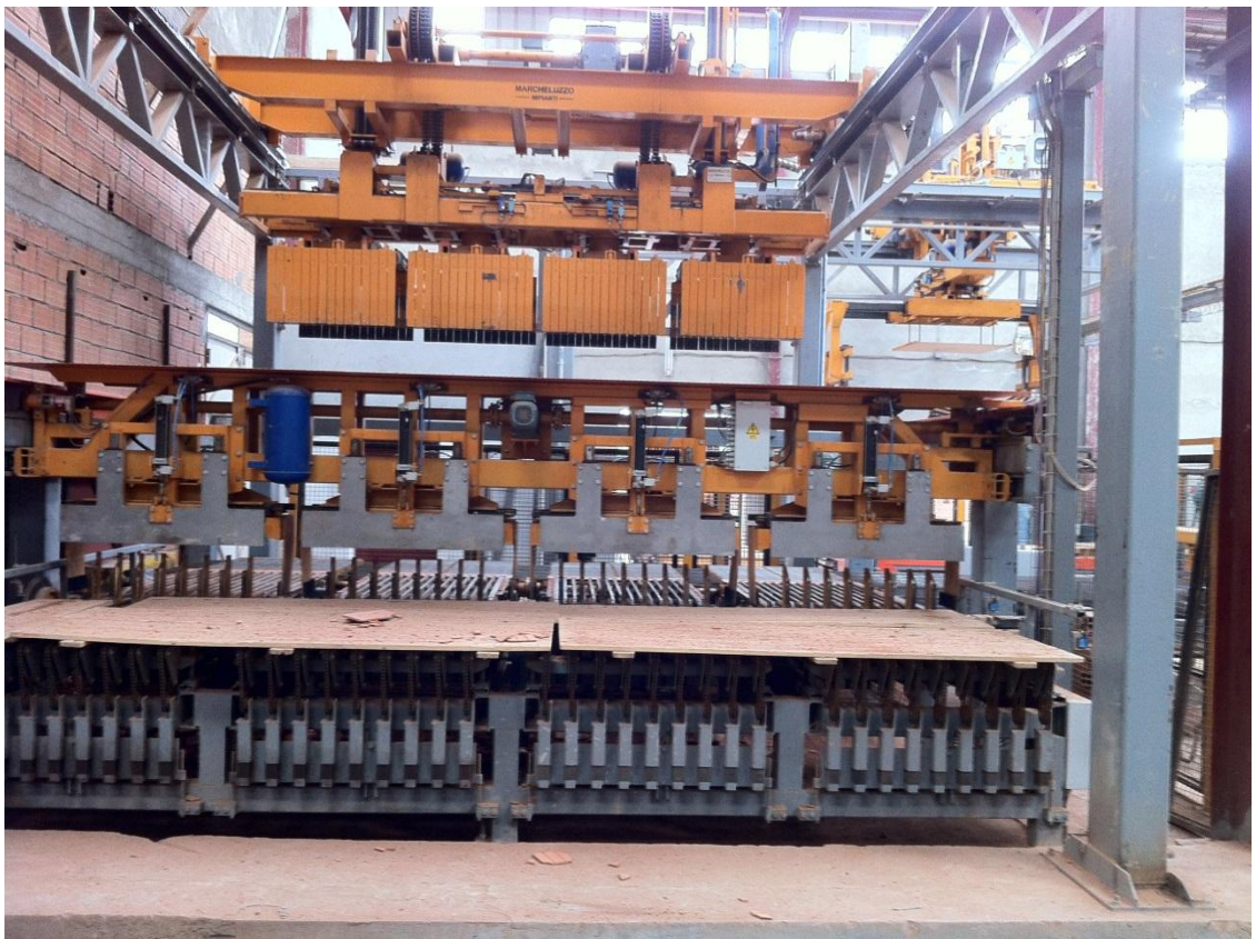
Figure I- 14.b : Dépileuse en mode couche par couche.
