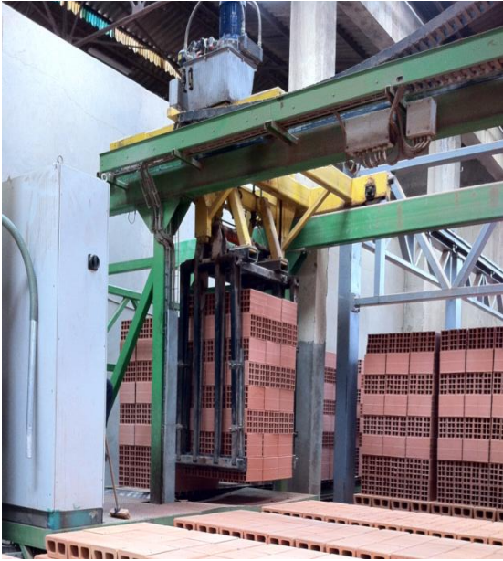
Figure I-14.a : Dépileuse en mode vrac.
