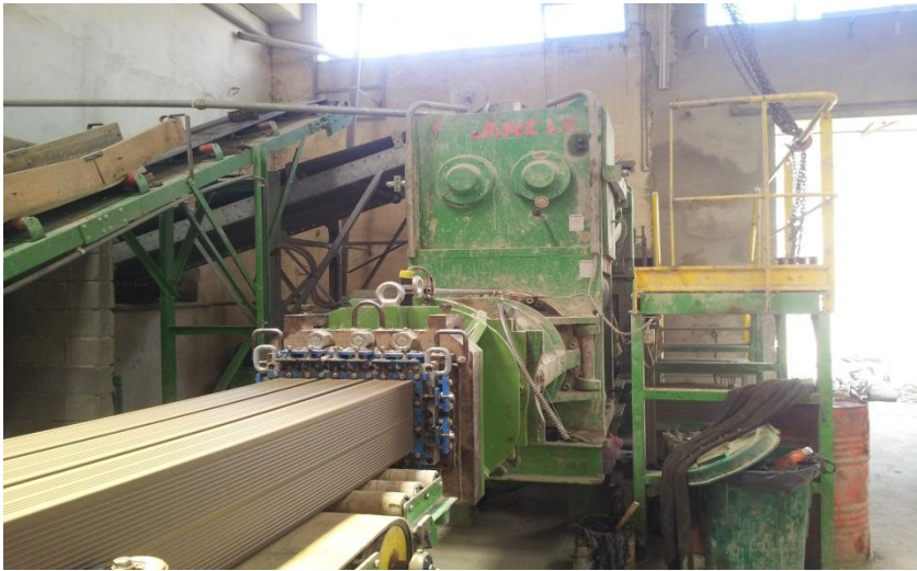
Figure I-7 : La mouleuse étireuse.
