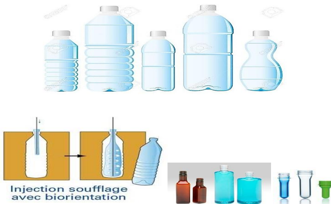
Figure 8 : Procédé injection soufflage avec biorientation
