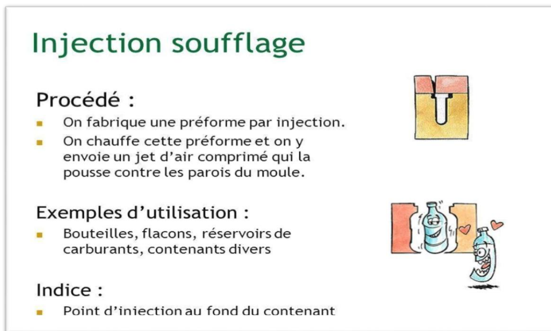
Figure 07 : Procédé injection soufflage
