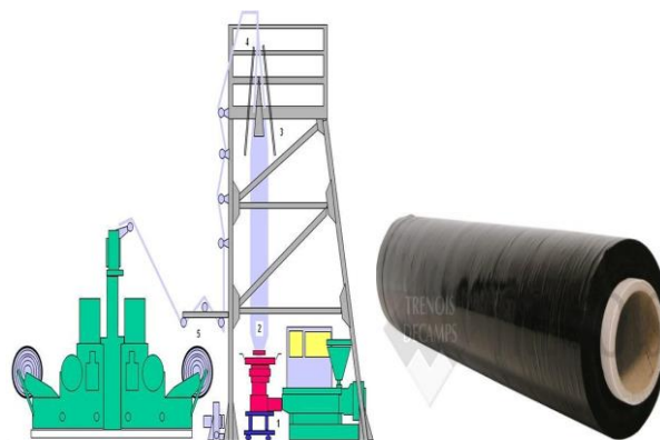
Figure 11 : Procédé extrusion gonflage
