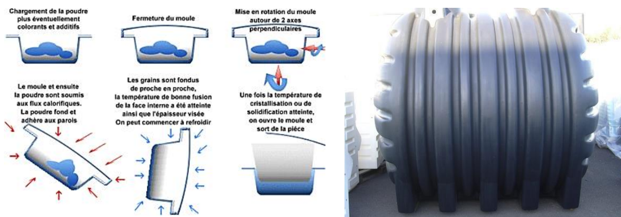
Figure 15 : procédé de roto-moulage [11]
